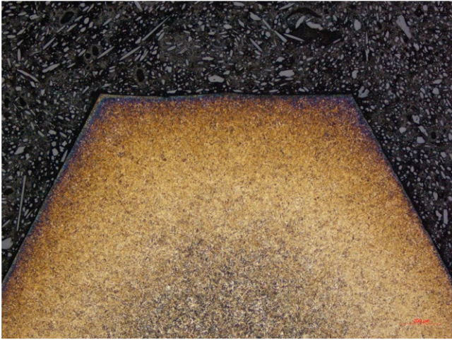
Geätzt mit 3% Nital, BF, 50x
