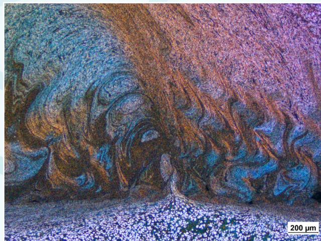
Aluminium reibrührgeschweißte, geätzt nach Barker, POL + Lambda Kompensator, 50x
