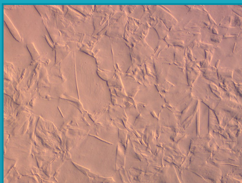
铜，微分干涉相衬衍射法，200倍，在Chemal抛光布上经过添加了化学试剂的碱性气相二氧化硅悬浮液抛光
